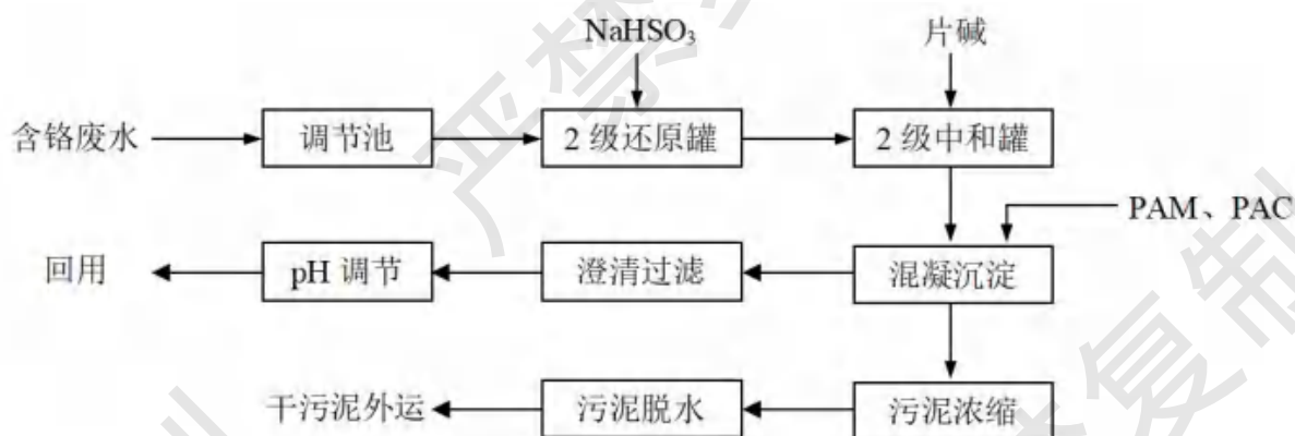
图 3.1-5 含铬废水处理工艺流程图
