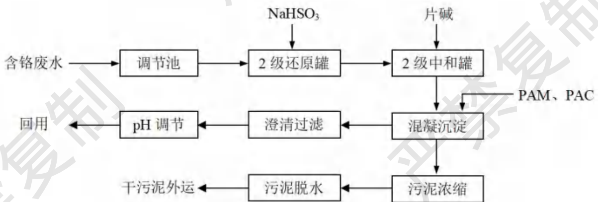
图 7.2-3 含铬废水处理工艺流程图
