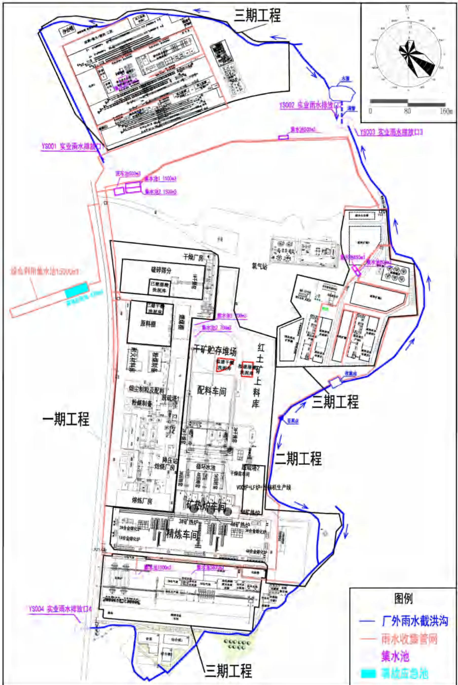
图 2.2-4 一期、二期、三期工程雨污水管网图
